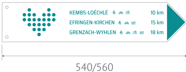
Indicateur standard – d'après l'entreprise Fett dimensions en mm (M1:10 à l'origine)
