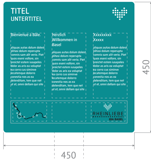
Petit panneau d'information 45 x 45 cm dimensions en mm (M1:10 à l'origine)
